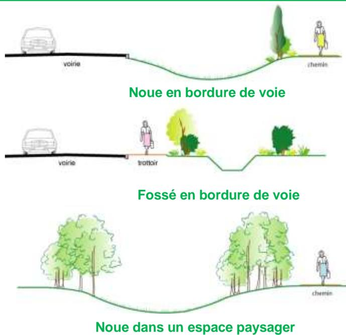
Les opérations d'aménagement prévoient des dispositifs de stockage et recyclage des eaux pluviales (arrosage des espaces verts, des jardins etc.).
